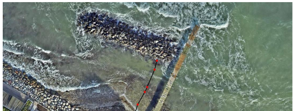
Figur 1.4: Situation hvor det ikke vurderes sikkert at krydse bølgebryder og GPS-opmålingen fra land derfor ikke når ud på 0.8 meters dybde.
